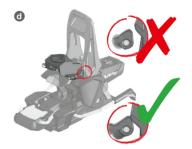
3 Fixierung Harscheisen/Fixation the crampon/Accrochage des couteaux/Fissaggio del rampante/Fijación de la cuchilla
